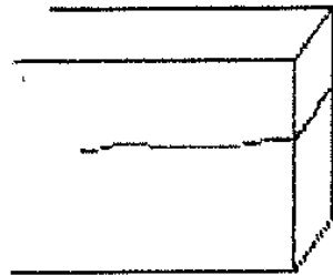
—不適切な打重ね処理— (コールドジョイント)
