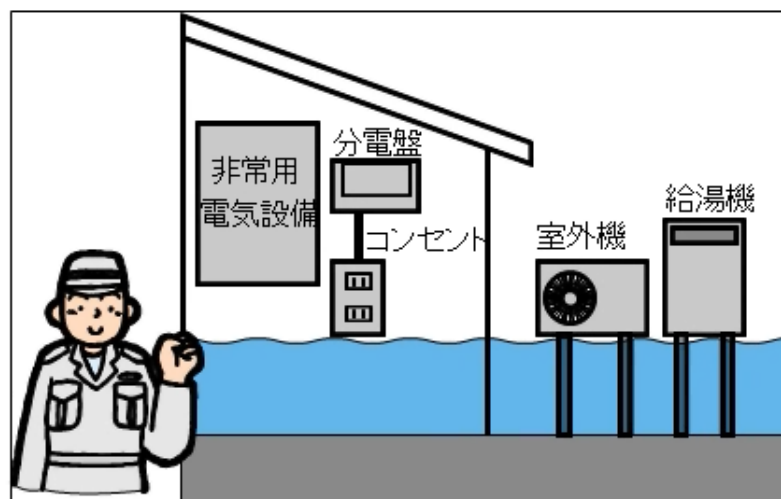
図 3-40 電気設備の浸水対策
