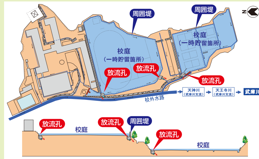
貯留した雨水は、放流孔(約10~20cmの小さな穴)から少しずつ校外へ流します
