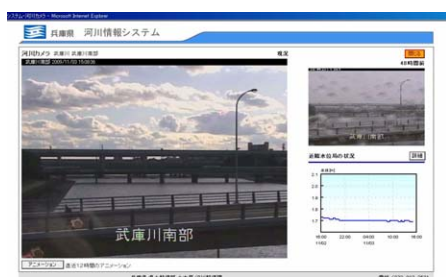
写真 4. 1. 4 河川監視カメラ画像の配信
